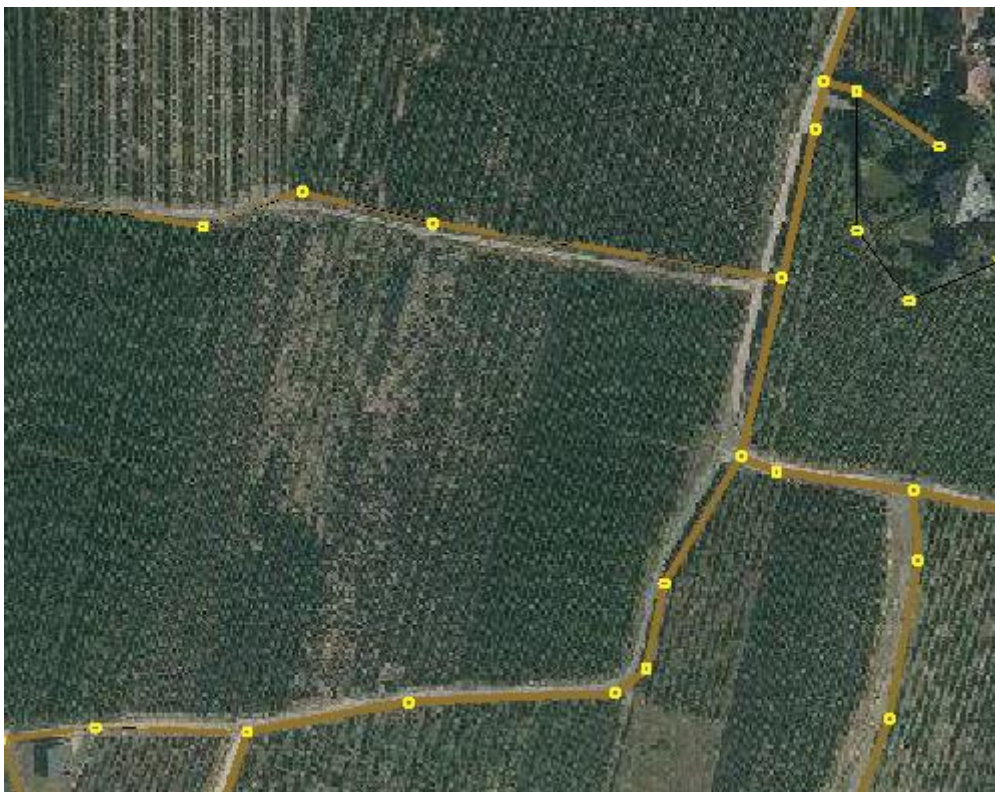
Abbildung 8: Beispiel für Lageabweichungen zwischen Modell und Örtlichkeit
