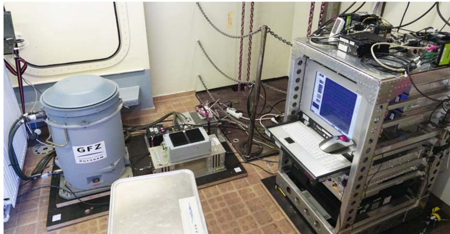
Das für die Messung von den Kollegen des GFZ Potsdam eingesetzte Seegravimeter vom Typ „Chekan“ (links) ist ein empfindliches und komplexes Messinstrument und arbeitet unter Laborbedingungen. Die Daten werden mit spezialisierter Computertechnik (rechts) aufgezeichnet.
