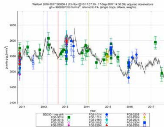
Schwerezeitreihe Wettzell: Kombination der Zeitreihe eines supraleitenden Relativgravimeters am Geodätischen Observatorium in Wettzell (durchgezogene Linie) und diskreten Beobachtungen mit verschiedenen Absolutgravimetern vom Typ FG5 bzw. FG5-X. In den Jahren 2010, 2013, 2015 und 2018 fanden Vergleichskampagnen statt. Gefüllte und nicht gefüllte Symbole unterscheiden verschiedene Ausrichtungen bei der Aufstellung der Instrumente.
