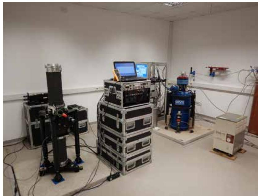
Parallele Beobachtungen des Absolutgravimeters FG5-227 (links) und des Supraleitgravimeters SG-038 (rechts) an der gravimetrischen Referenzstation AGGO, Argentinien
