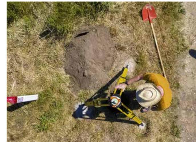
Um im Millimeterbereich GPS-Koordinaten zu ermitteln, muss das Stativ über der unterirdischen Vermarkung hochpräzise zentriert sein.
